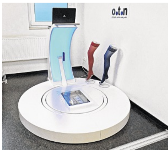
Der 3D-Scanner zur Kompressionsmessung. DORFER
