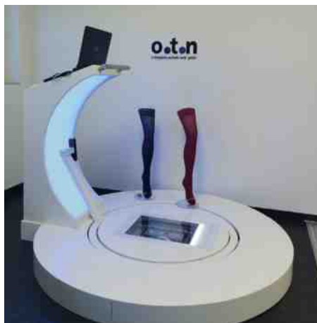
Neues Messsystem mit 3D-Infrarot-Scanner bei o.t.n
